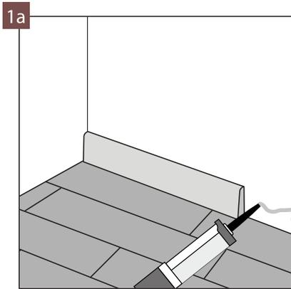
Dilatationen entlang den Wänden sollen mit passenden anhand von Klebstoff oder Klips montierten Sockelleisten zugedeckt werden.
