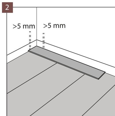
2 Lassen Sie zur Wand einen Abstand von ca. 5 mm. Die maximale Fläche, die ohne zusätzlichen Abstand zu verlegen ist, beträgt 200 m<sup>2</sup>. Bei der Verlegung in den größeren Räumen ist der zusätzliche Abstand einzuhalten sowie alle Abstände bis auf 10 mm zu vergrößern. Maximale Flächenlänge in einer Richtung, die ohne zusätzlichen Abstand zu verlegen ist, beträgt 20 m.
