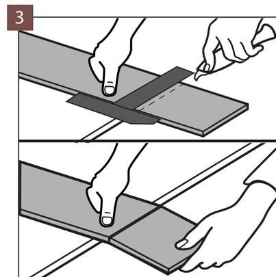
3 Verwenden Sie zum Zuschneiden der Bodenpaneele ein scharfes Messer, schneiden Sie die obere Schicht ein, danach knicken Sie energisch das Paneel nach unten weg. Die Bodenpaneele können auch mit einer elektrischen Säge zugeschnitten werden.
