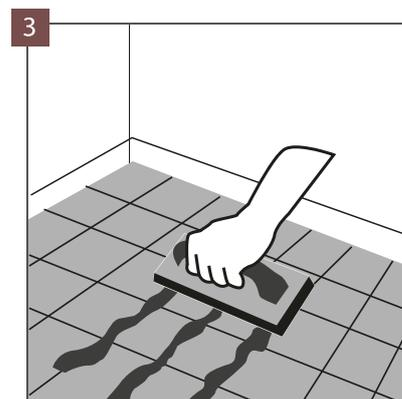
Bei der Verlegung auf keramischen Fliesen soll die Fugenbreite nicht mehr als 4 mm und die Tiefe nicht mehr als 1 mm betragen. Größere Abstände sind mit Harzmasse auszufüllen. Der Boden kann auf Fliesen mit Fugen mit einer Breite von bis zu 5 mm und einer Tiefe von 1 mm ohne deren Ausgleich verlegt werden, unter der Voraussetzung, dass eine geeignete Unterlage verwendet wird.
