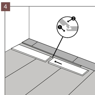
4 Die Bodenpaneele werden mit den Verschlüssen, die auf der kurzen und der langen Kante zu verbinden sind, versehen. Zuerst müssen die kurzen Kanten der Paneele miteinander verbunden werden.
