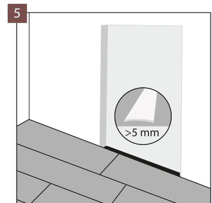
In folgenden Fällen ist in der Türöffnung zwischen den Räumen eine Dilatation von 5 mm zwecks Spannungsabbau anzuwenden: unregelmäßige Form des Fußbodens in benachbarten Räumen, schwere Möbel in einem der Räume, aktivierte Bodenheizung nur in einem der Räume im Objekt. Bei einer Fläche von über 200 m<sup>2</sup> und/oder länger als 20 m<sup>2</sup> ist eine 10 mm Dilatation notwendig.
