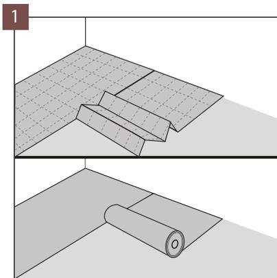
1 Verlegen Sie die Unterlage und/oder Trittschalldämmung quer zur Verlegerichtung der Paneele. Legen Sie die Nebenbahnen bündig aneinander an, lassen Sie sie überlappen oder verbinden Sie sie mit Klebeband AluTape. Vermeiden Sie Abstände.
