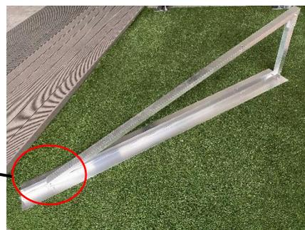
Hinweis: Der Konsolenfuß ist länger als das PV Modul. Dies soll bei Sturm verhindern, dass die Konsole vorn herüber geweht werden kann. Den Überstand bitte nur bei fester Verschraubung mit dem Dach kürzen!
