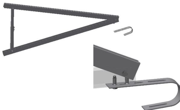
(3) Platzieren Sie das 30x30mm - Vierkantrrohr am unteren Ende der Konstruktion, richten Sie es an der vorbestimmten Lochposition aus und fixieren Sie es mit den M8x55mm-Schrauben.
