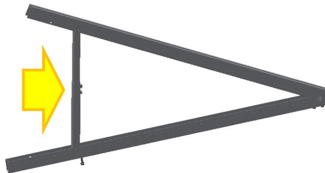
(2) Verschrauben Sie den Balkenhaken mit dem unteren Träger des Stativs.
