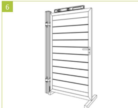
6 | Die waagerechte Ausrichtung des Torelements mit der Wasserwaage kontrollieren, gegebenenfalls korrigieren und mit einer Holzleiste stabilisieren.
