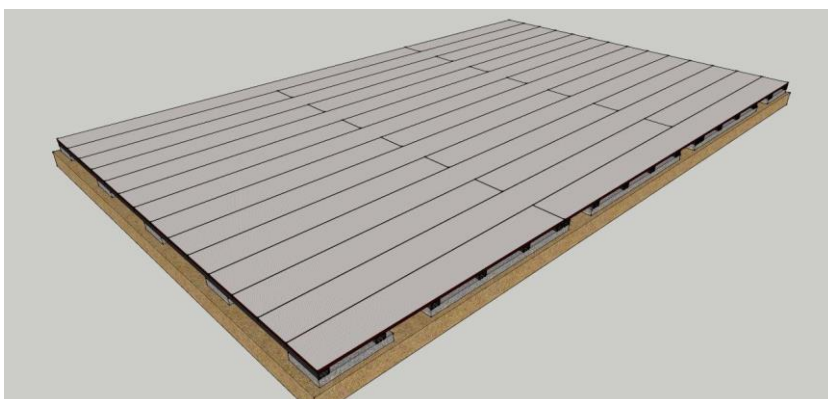
Abb. 3: Fertiges Deck mit versetztem Stoß
