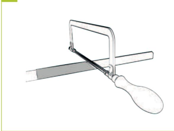
6b | Markieren Sie mit Hilfe der mitgelieferten Schablone den Gehrungsschnitt. Sägen Sie das Abschlussprofil mit einer Metallsäge passend zu und setzen Sie diese anschließend auf das Zaunelement. Optional kann das Abschlussprofil mit zwei Schrauben fixiert werden.
